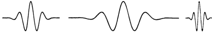
FIGURE 2 – Dans l’analyse en ondelettes, on comprime et étire une ondelette mère (à gauche) selon la taille de l’intervalle à étudier. Le signal est ainsi analysé à des échelles différentes. Les ondelettes larges donnent une image approximative (ou floue) du signal, tandis que les fenêtres étroites permettent de zoomer sur les détails.
